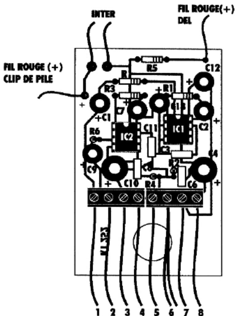
Vous trouverez ci-dessus toutes les indications pour réaliser le câblage de votre amplificateur pour baladeur. Pour que cet objet technique puisse fonctionner, il faut obligatoirement « tirer » des fils électriques entre ses différents composants électroniques. Utilisez ces renseignements pour compléter le schéma suivant.
