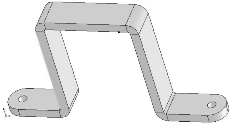
**Réalisation d'une pièce en PVC par pliage**
