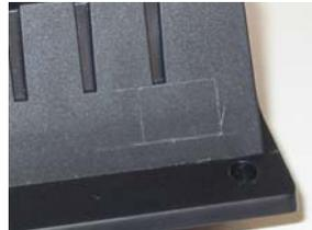
Tracez la position du logement de l'interrupteur sur le boîtier n°01.
