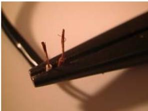
Dénudage, torsadage et étamage des fils du câble blindé.
