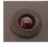
Mise en place DEL dans le clip de DEL
