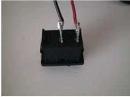
Brasage des fils sur l'interrupteur
