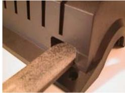
Ajustez les dimensions du logement avec une lime.
