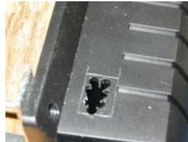
Faites des perçages dans le logement de l'interrupteur
